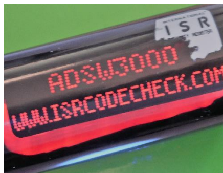
(bilden visar ISR-märkning i UV-ljus efter att dekalen delvis avlägsnats)
